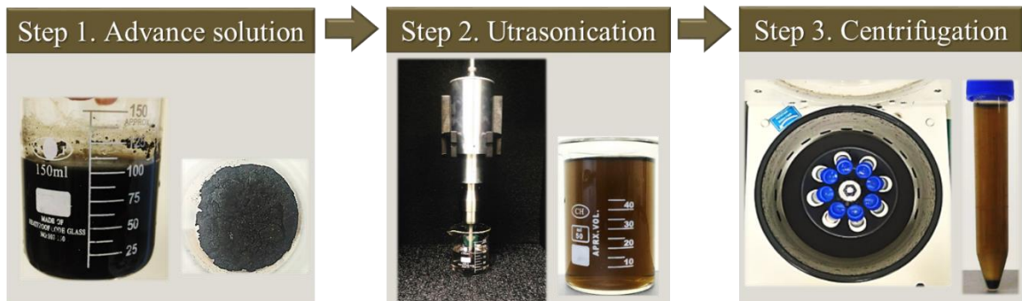
圖八液相剝離法製作石墨烯微奈米粉末的過程
